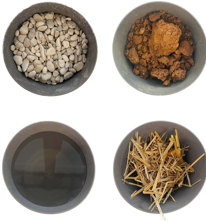
Matières premières : granulats, terre crue, eau et paille ©nm architecte
