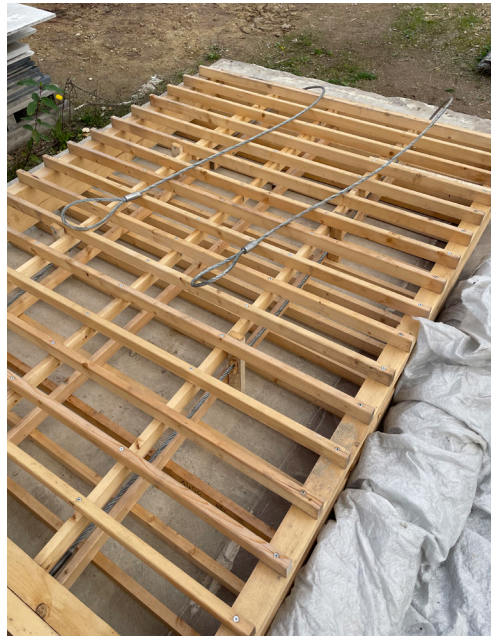
Maquette des murs en terre crue et de l'armature en bois (en haut à gauche) ; Armature en bois et filins acier (en bas à gauche) - usine FEHR, Achern, Allemagne ; Coupe de principe d'un mur en terre crue coulée (à droite) ©nm architecte
