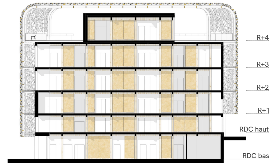
Coupe sur le bâtiment "lien" dans la médiathèque James Baldwin au niveau des murs en terre crue coulée ©atelier Philippe Madec
