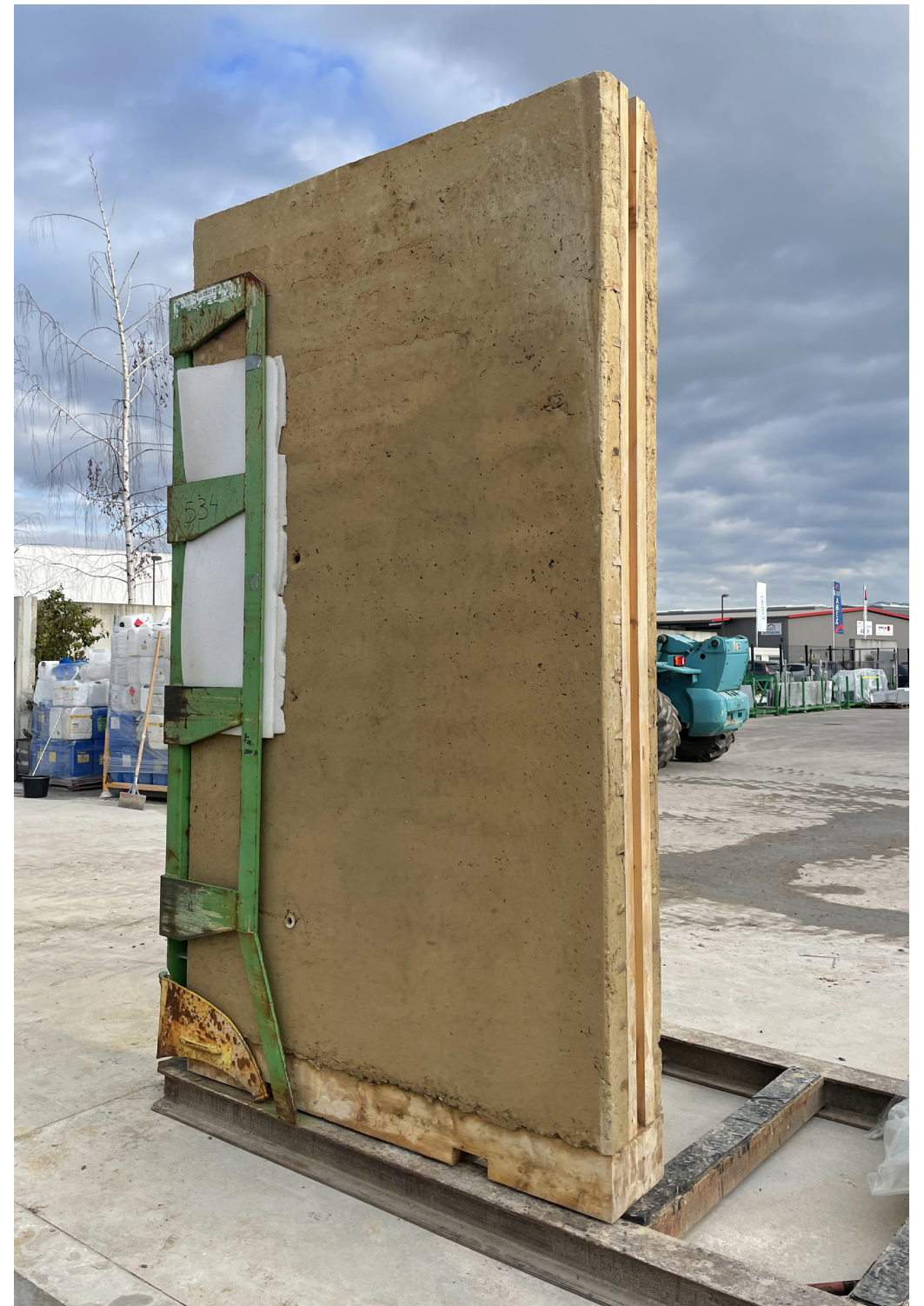
Mur en terre crue coulée décoffré et posé sur un rack FEHR - usine FEHR, Achern, Allemagne ©nm architecte
